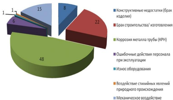
Рис. 1. Распределение причин аварийности на магистральных газопроводах
