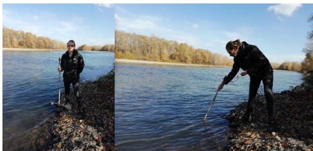
Рис. 6 Измерение скорости водного потока гидрологической вертушкой.
