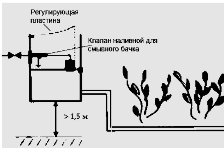
Рис. 1 - Схема установки клапана
